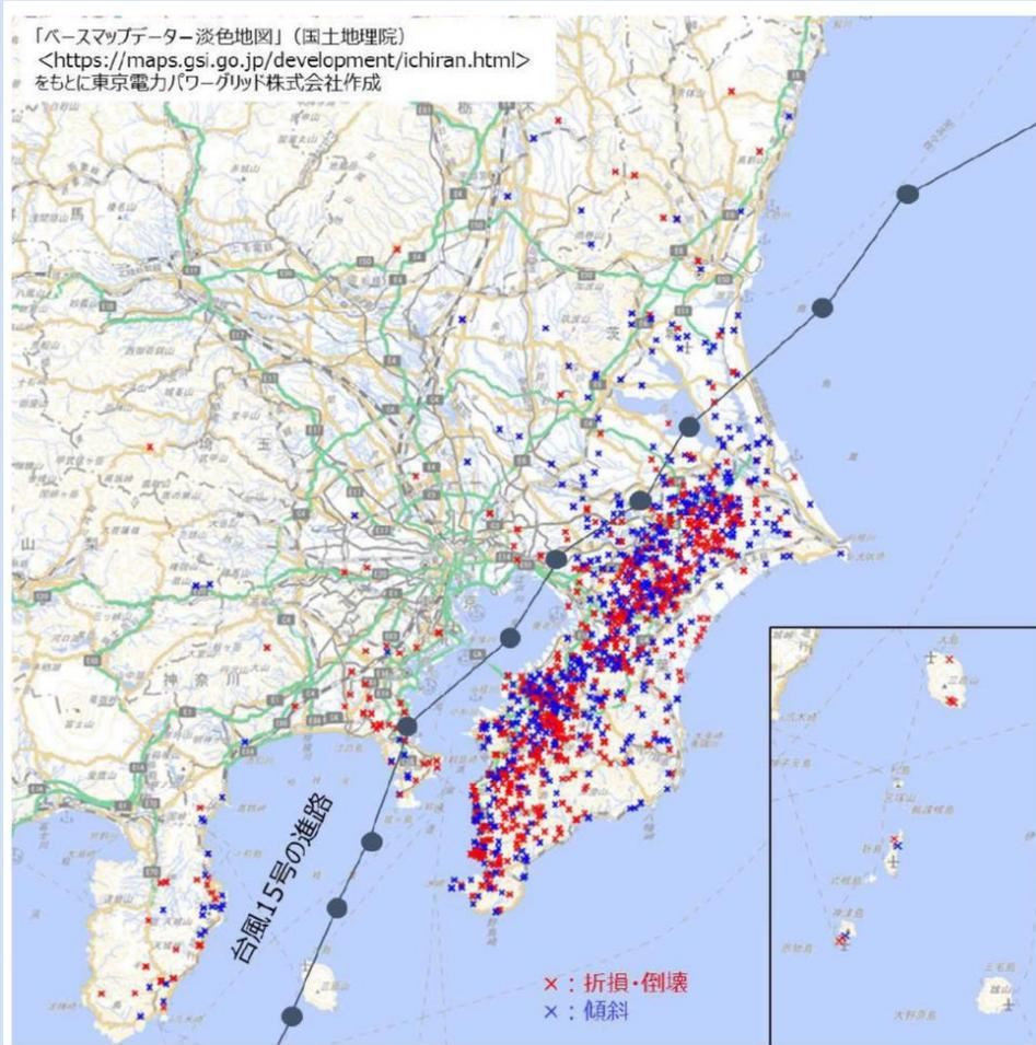
図4：台風15号の影響による電柱の被害発生状況(分布図)
